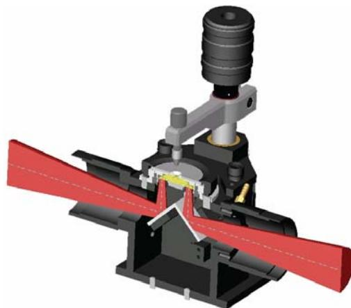
**Figura 9.** Esquema óptico do acessório de ATR Pike MIRacle.
