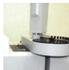
GC-MV 4000 Varian cromatógrafo gasoso com espectrômetro de massa. Aplicado na separação, quantificação e identificação de compostos orgânicos.
