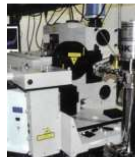
Espectrômetro Raman dispersivo T64000 Horiba Permite a identificação de materiais e estudos da estrutura cristalina de materiais em diversos formatos e tamanhos.
