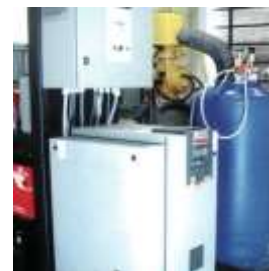
Liquefator de Nitrogênio Stirling Produz 10L/h de nitrogênio líquido com pureza de 99%.
