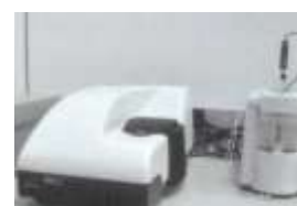
Potencial Zeta – Zetasizer NanoS2 Malvern Permite medir tamanho, potencial zeta e massa molecular de partículas ou moléculas em solução.
