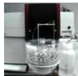
Espectrofotômetro Absorção de Atômica de Alta Resolução Contra300 - Analytik Jena AG (atomizador de chama) Aplicado na identificação e quantificação de diversos elementos químicos.
