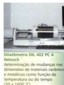
Dilatômetro DIL 402 PC 4 Netzsch determinação de mudanças nas dimensões de materiais cerâmicos e metálicos como função da temperatura ou do tempo. (20 a 1600 °C).
