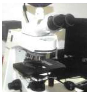
Microscópio ótico Axioskop 40 A Pol – Zeiss com iluminação transmitida e refletida, com objetivas de 10x a 100x, polarizador e filtro RGB.
