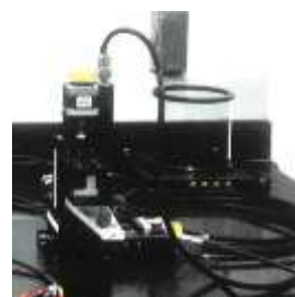
Microscópio eletroquímico Modular SECM Aplicado na visualização local de atividade eletroquímica da superfície de amostra.
