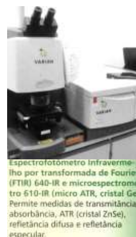
Espectrofotômetro infravermelho por transformada de Fourier (FTIR) 640-IR e microespectrometro 610-IR (micro ATR, cristal Ge) Permite medidas de transmitância/absorbância, ATR (cristal ZnSe), refletância difusa e refletância especular.
